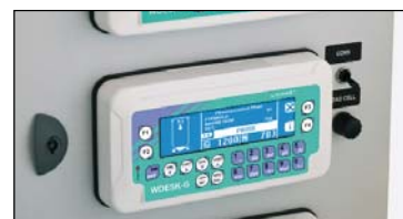
Montaggio a fronte quadro Panel mounting
